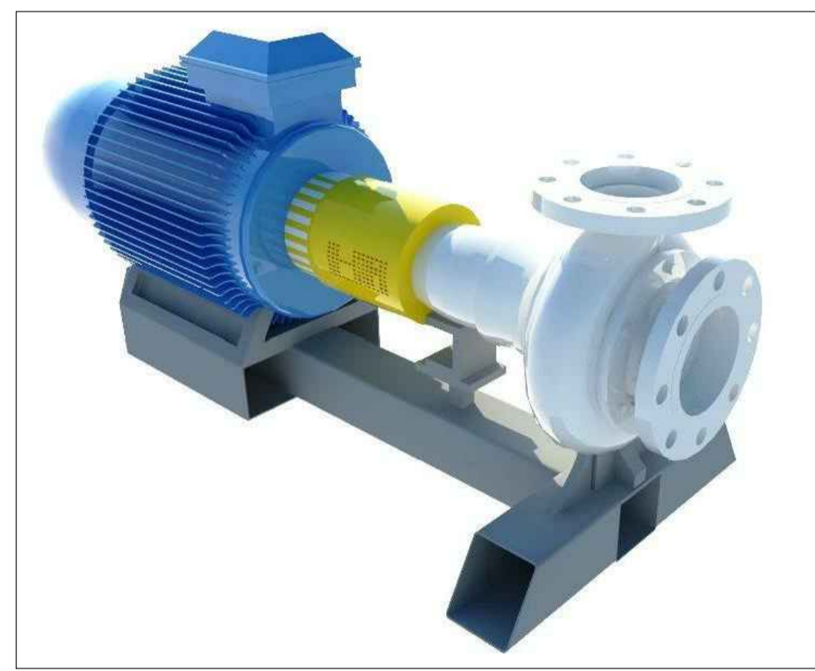
CONJUNTO MOTOR-BOMBA POÇO SECO
